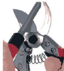
Flat: Upper edge sharpening
